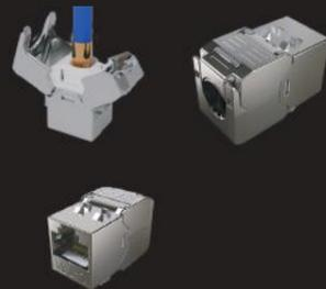
Als Telekommunikationsanschlussmodul für anwendungsneutrale Telekommunikationskabelanlagen der Verkabelungskategorie 6<sub>A</sub> oder Anwendungen bis 10GBase-T. Das Keystone Modul passt in alle gängigen Keystone Trägersysteme. Kurze Ausführung 28mm, PoE+ gemäß IEEE 802.3at
