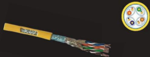
Installationskabel für den Einsatz in strukturierter Gebäudeverkabelung nach ISO/IEC 11801 und EN 50173-1. Bestens geeignet für alle Anwendungen der Klassen D bis FA Multimedia (Video, Daten, Sprache), > 10GbE nach IEEE 802.3af/at/bt, 25GB, 40GB bis 30m, VoIP, PoE, PoE+
